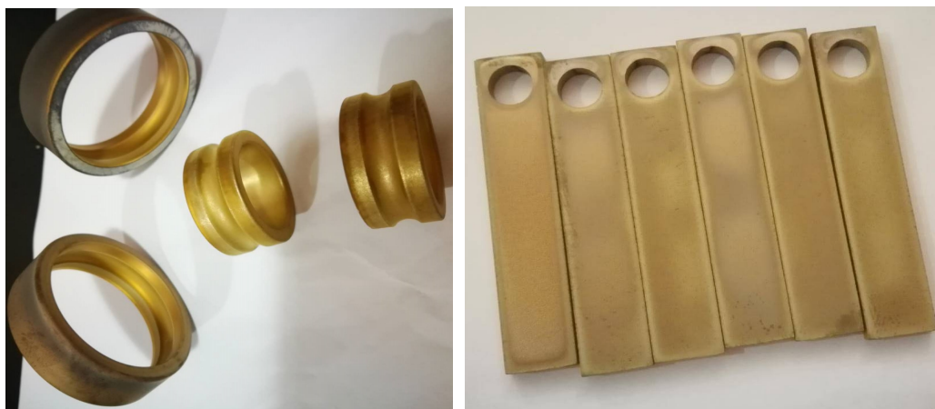
图 7-8 钛合金样品表面离子渗氮
