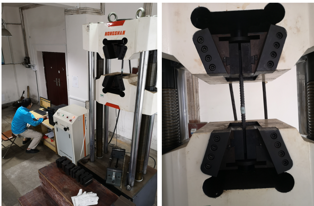
图 7-3 我校学生螺纹钢质量检测
